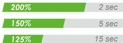
电机类型的待测物，例如马达、压缩机、水泵等，在启动瞬间往往会产生极高的启动电流，导致用户往往得选购容量远高于待测物额定功率之电源。AFC 系列的具备选配之过载能力，可承受高达过载 200%，能轻松启动带有高启动电流之电机类产品。
